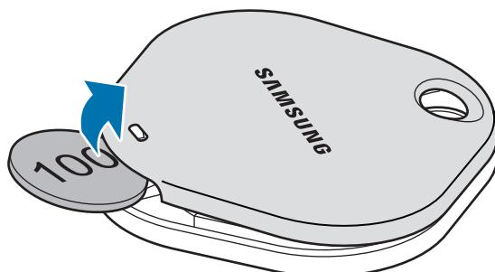
2 Stavite bateriju sa pozitivnim terminalom pravilno poravnatim sa + simbolom unutar SmartTag-a.
